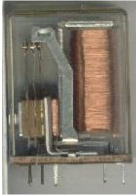
Figure 9 : photo d'un relais - image issue de Wikipédia
