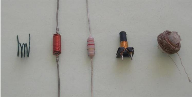
Figure 13 Différentes bobines HF [2]
